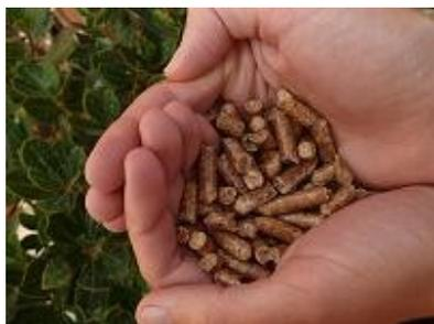
La Biomasa es un combustible ecológico de origen vegetal o animal. Se utiliza bien como combustible sólido (pellets, astillas, etc.), bien como combustible líquido (bioetanol, biodiesel) o como biogás.
